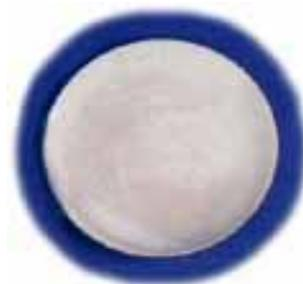
Depósitos espesos tintados con una solución de yodo
