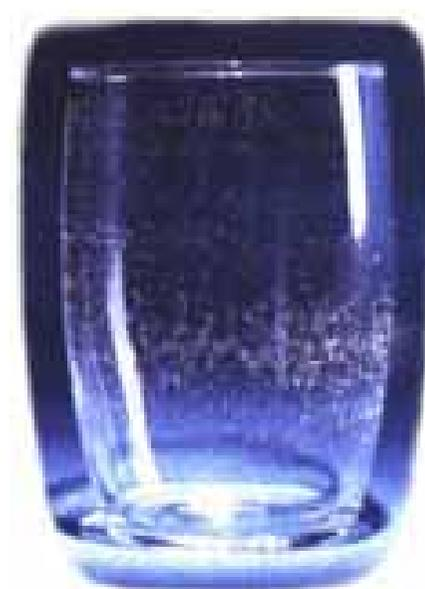
después del primer lavado. Se entiende que en este caso también se trata de un deterioro de la superficie del vaso, pero que se ha producido durante el proceso de fabricación o en su trayecto hasta llegar al consumidor. Este deterioro se irá agravando rápidamente debido a las condiciones del lavavajillas.
