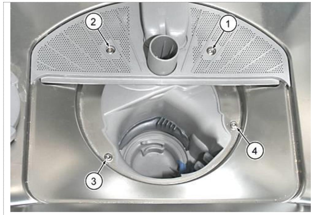
松开内部容器中的 4 个螺钉 (1. 至 4.), 向下拆除循环仓。
