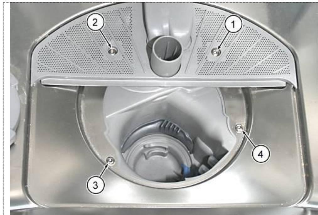
Aflojar los 4 tornillos (de 1 a 4) del recipiente interior y extraer la cubeta de lavado hacia abajo.
