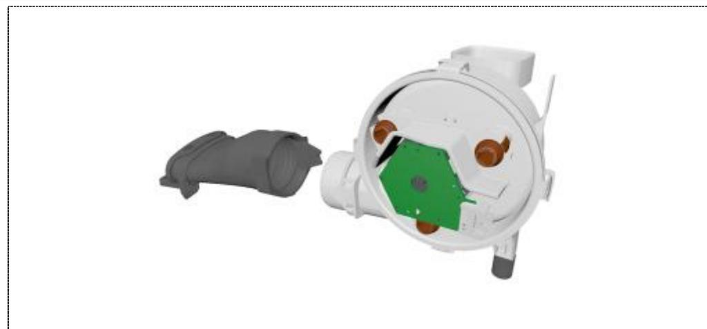
1. Quitar el motor del ventilador con la carcasa del ventilador del canal de aire.
