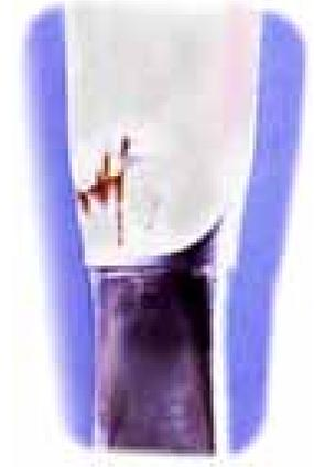
Sie ist gleichzeitig auch das klassische Beispiel im Zusammenwirken mit dem maschinellen Spülen. Spannungsrisse beziehungsweise Härterisse treten vor allem bei Messerklingen im Bereich von Sägeschliffen und, vom Messerrücken ausgehend, in Richtung Klingenschneide auf. Das alkalische Reiniger-Medium wirkt hierbei generell korrosionsmindernd.
