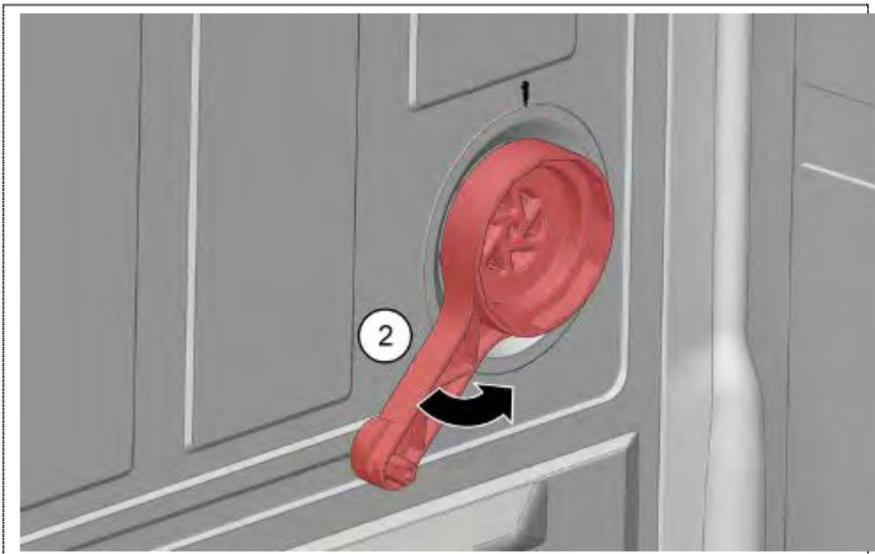
1. Retirer l'écrou de l'ouverture d'expansion avec l'outil spécial.
