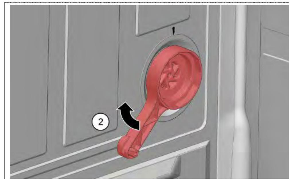
1. Fixer l'écrou d'ouverture d'expansion jusqu'au repère indiqué.
