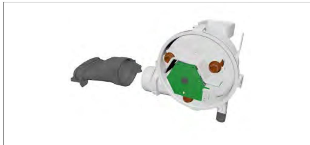
Retirer le moteur de ventilation du canal de ventilation
