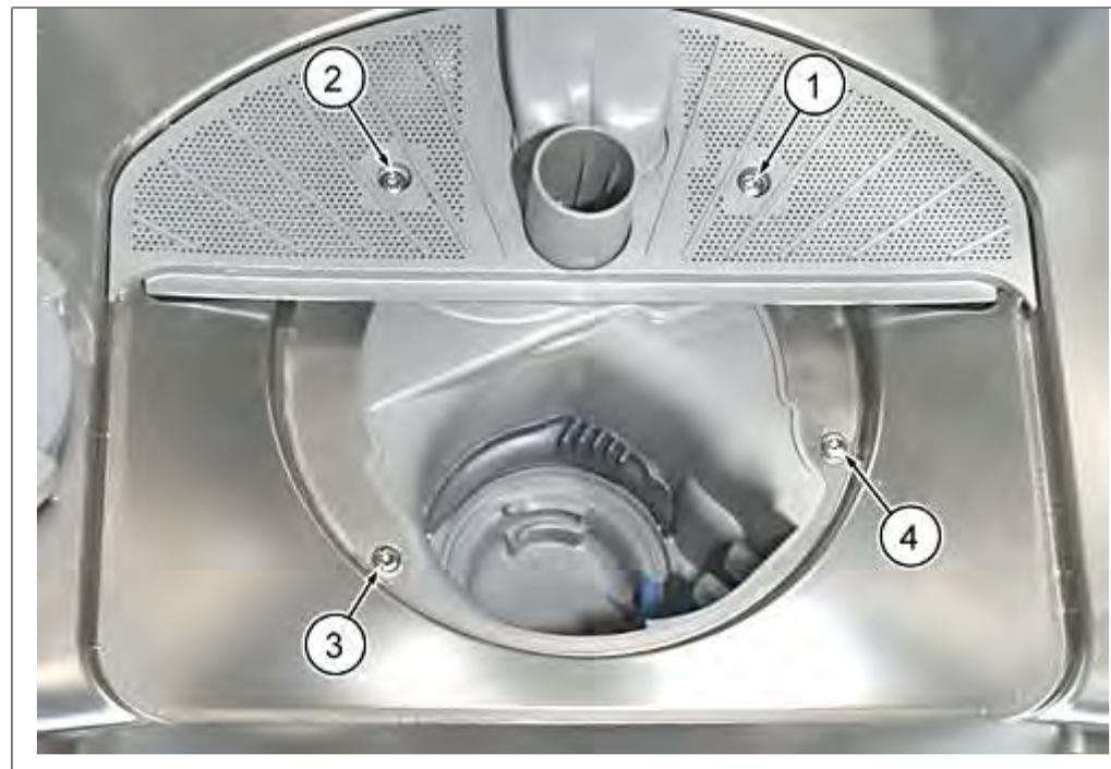
Défaire 4 vis (1 à 4) dans le bac intérieur et retirer le bloc hydraulique par en bas.
