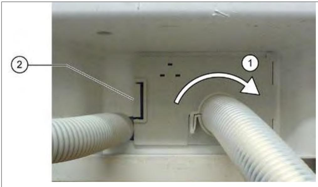
Retirer le passage de tuyau du bac du socle.
